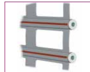
L'anneau anti-tempête empêche le tablier d'être arraché ou poussé hors des glissières par le vent (en option).
